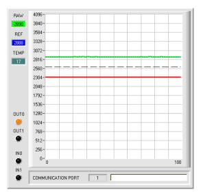
Solange der aktuelle Messwert **RAW** (grüne Linie) oberhalb der Schaltschwelle (rote Linie) liegt, ist der Ausgang **OUT0** auf +24V (Signal ist in Ordnung). Dies wird über die LED **OUT0** visualisiert
