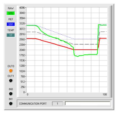
Im Beispiel wurde für TT DOWN ein Wert von 50 gewählt. Das bedeutet, dass die Schwellennachführung nach unten relativ langsam durchgeführt wird.
