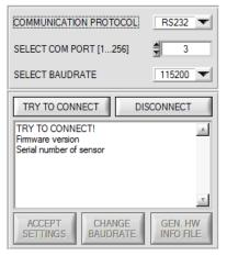
Die Baudrate zur Datenübertragung über die RS232 Schnittstelle kann mit **SELECT BAUDRATE** und **CHANGE BAUDRATE** eingestellt werden.
