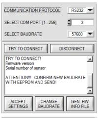
Nachdem die neue Baudrate erfolgreich übertragen worden ist arbeitet der Sensor mit der neuen Baudrate. Außerdem erscheint im Anzeigefenster eine Aufforderung **EEPROM** zu selektieren und anschließend **SEND** zu drücken. Erst nach Drücken von **EEPROM** und **SEND** wird bei einem Hardware-Reset mit der neuen Baudrate gestartet.
