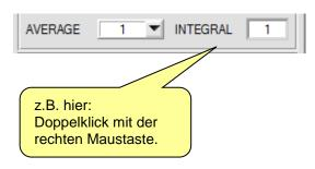
Um zur Offsetkalibrierung zu gelangen, muss in der Registerkarte PARA ein Doppelklick mit der rechten Maustaste exakt auf den Rahmen unterhalb INTEGRAL durchgeführt werden.
